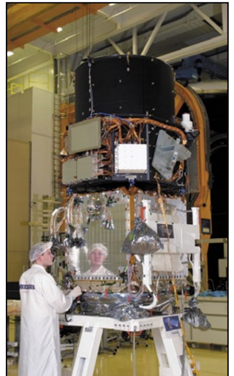
Plateforme et charge utile sont à présent assemblées, mais encore dépourvues de leur revêtement protecteur. © Alcatel space/CNES.
