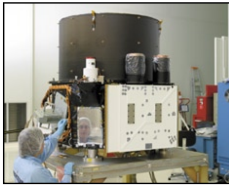
Calipso pendant sa construction. La charge utile est préparée avant son installation sur la plateforme. © Alcatel space/CNES
